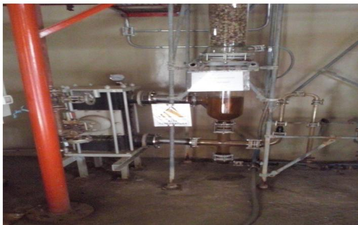
Figura 2.34 Columna de destilación continua
