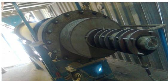
Figura 2.33 Secador rotatorio
