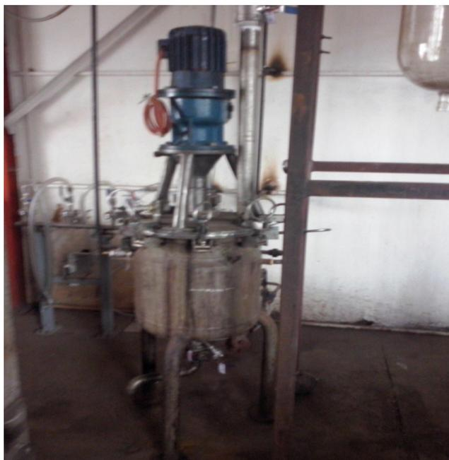
Figura 2.35 Evaporador continuo
