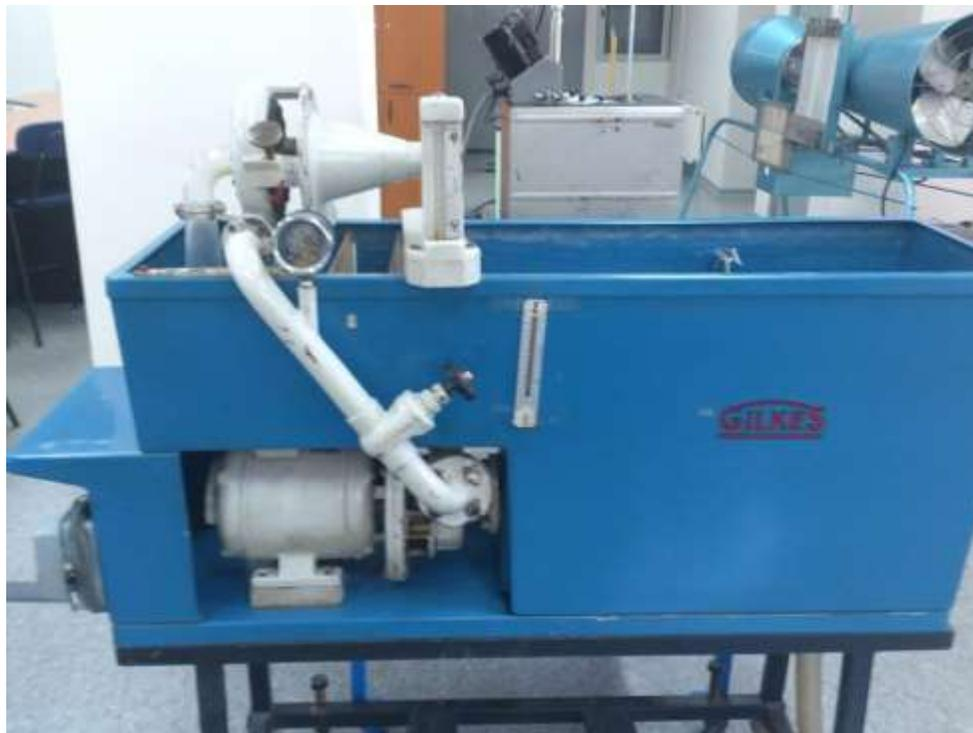
Fig.38 Banco de pruebas GILKES motor-bomba-turbina.
