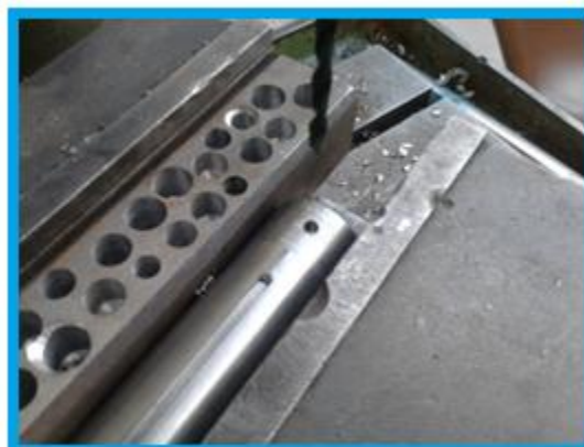
Figura 3.3 Perforación del pistón para el sistema de sujeción.
