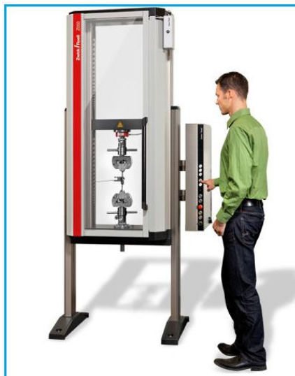
Figura 4.9. Máquina de ensayo universal Zwick / Roell BT1-FB100TN utilizada para la experiencia.
