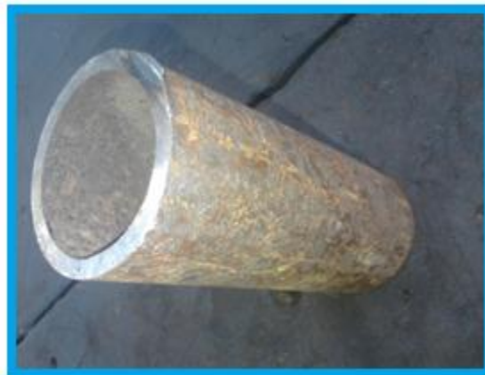
Figura 3.5 Camisa de acero para el sistema de guía del pistón.
