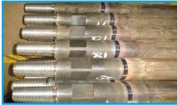
Figura 2.26 Drill rods soldados en sus extremos por fricción.
