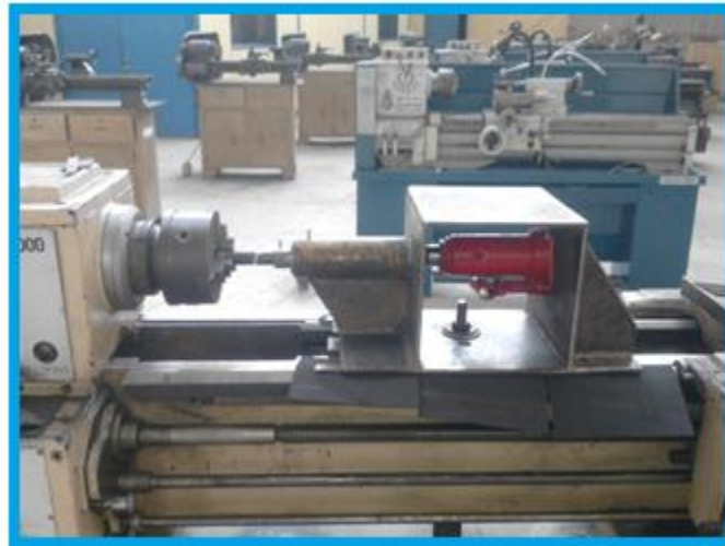
Figura 3.8 Montaje de mecanismo de soldadura por fricción en un torno convencional.
