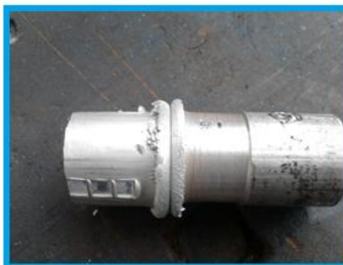
Figura 4.6 Experiencia de soldadura por fricción directa aleación de aluminio – aleación de aluminio, barra de diámetro 25 mm.
