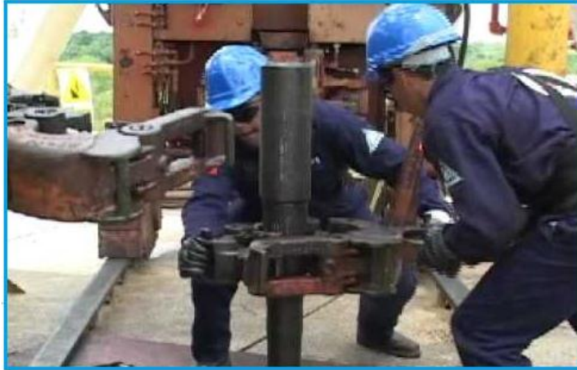
Figura 2.28 Faena petrolera, utilización de drill pipes soldados por fricción.
