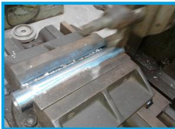
Figura 3.2 Fabricación del sistema de guía para el pistón.
