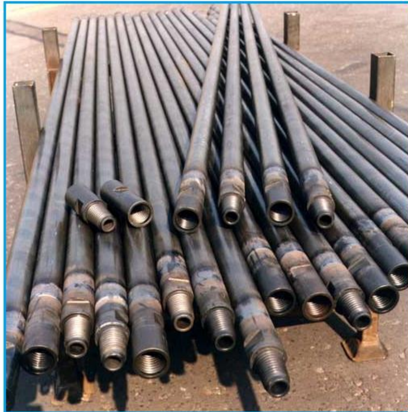
Figura 2.29 Drill pipes utilizados para la obtención de petróleo, soldados en sus extremos por fricción.
