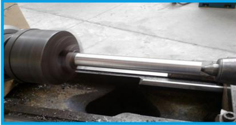
Figura 3.1 Mecanizado del pistón guía del mecanismo.
