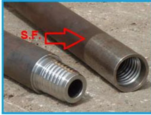
Figura 2.25 Drill rods usados para la perforación del suelo en busca de agua, soldados en sus extremos por fricción.
