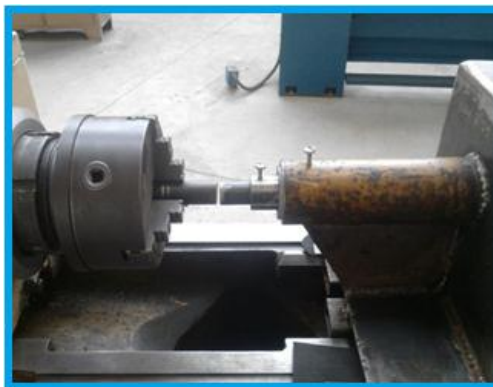
Figura 4.2 Montaje de las piezas a soldar, una en el cabezal del el torno y la otra en el extremo de nuestro pistón del mecanismo.
