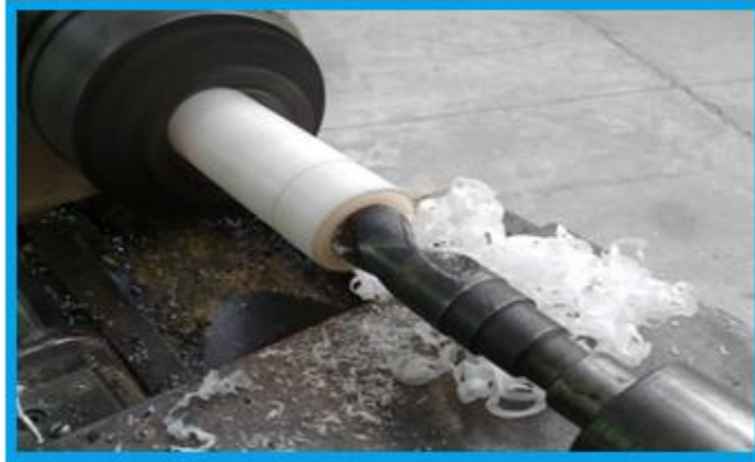
Figura 3.4 Mecanizado del cojinete de teflón.
