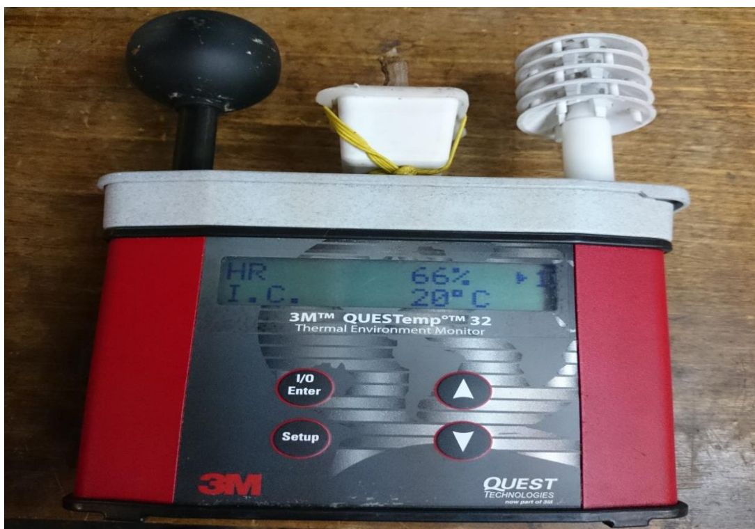
Figura 5.1 Equipo para medir la humedad relativa y temperatura.
