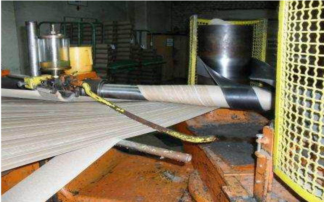
Figura 4.3. formación del caño de cartón.
