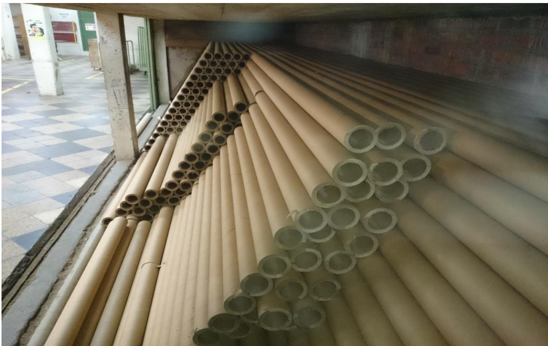
Figura 4.5 Horno secador a plena carga de caños (vista interior).
