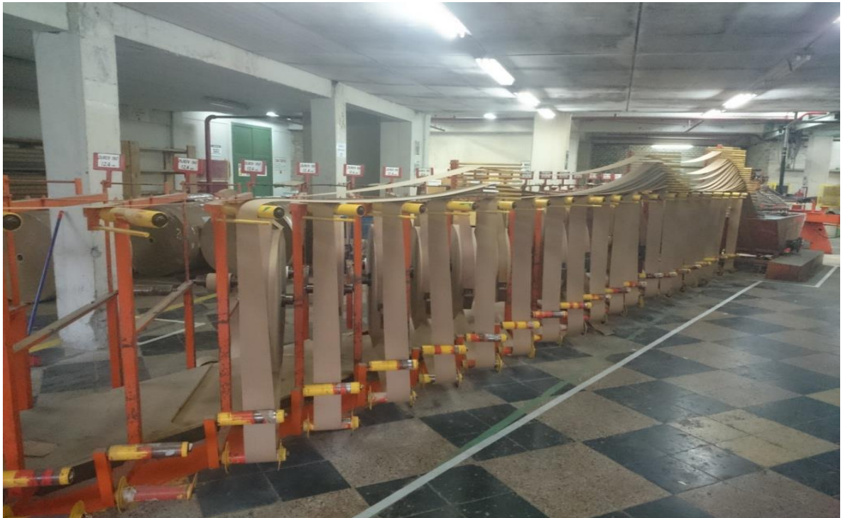
Figura 4.1 Rodelaas de cartón desenrollándose en el proceso.
