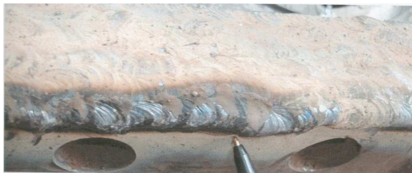
Figura 3.2 Acercamiento del cordón depositado con CITODUR – 600 en la recuperación del yunque del astillador
