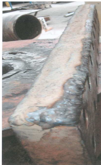
Figura 3.1 Detalle de la dirección del cordón con CITODUR – 600 en la recuperación del yunque del astillador.
