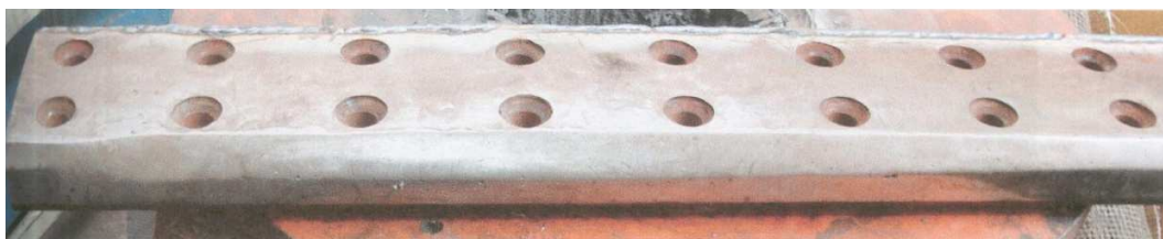
Figura 5.1 Yunque del astillador desgastado
