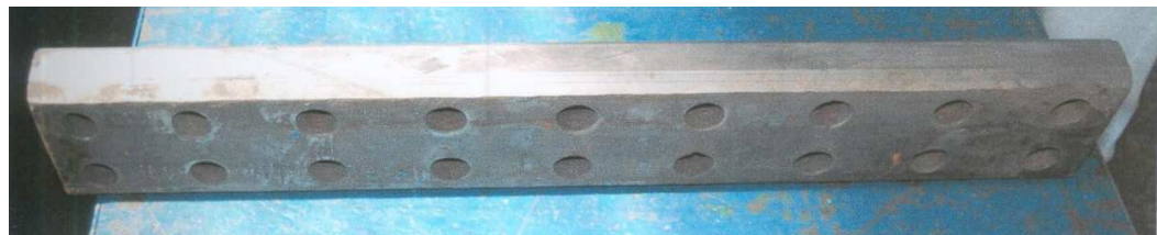
Figura. 3.4 Yunque del astillador recuperado con electrodo CITODUR - 600
