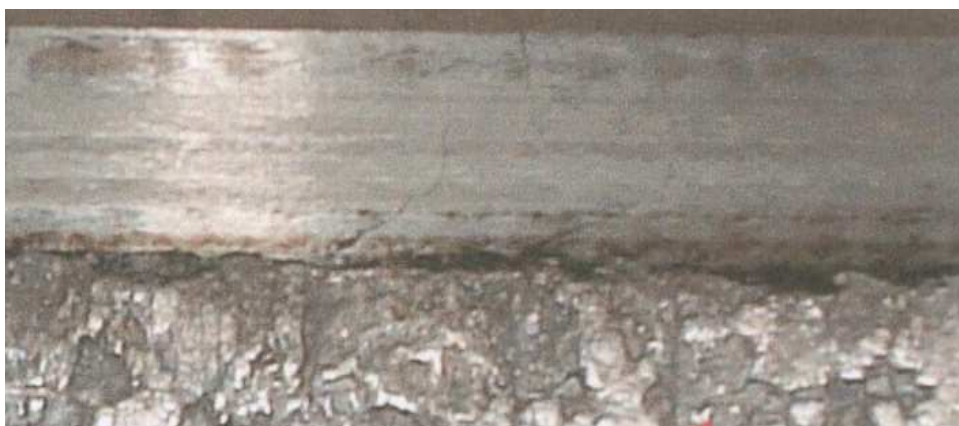
Figura 5.3 Más detalles del desprendimiento electrodo TUNGSTEL
