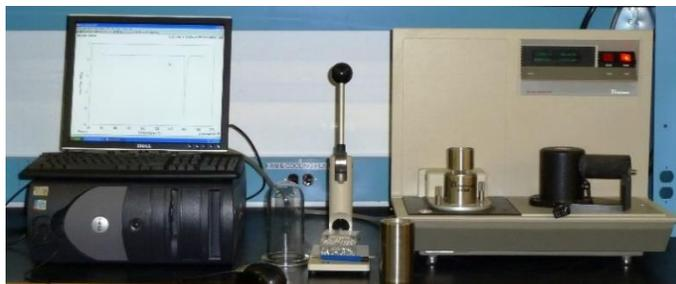
**Figura 2.1.** Equipo DSC 2920 Modulated.
