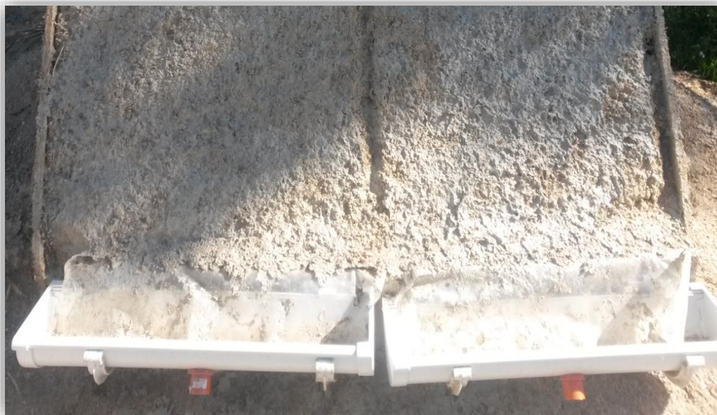
Figura 4: Canaletas de recepción de material (Fuente: Elaboración propia)
